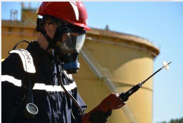
L'Ultra RAE est un détecteur de contrôle ponctuel, généralement utilisé par le personnel chargé du contrôle des risques professionnels tels que la présence de Benzène, Butadiène.
