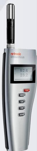
L'HygroPalm22-A peut être utilisé avec tous les capteurs HC2 de ROTRONIC. Cet appareil mesure l'humidité relative et la température, peut effectuer tous les calculs psychrométriques, affiche la tendance et dispose d'une fonction «Hold» pour geler la valeur de mesure.
